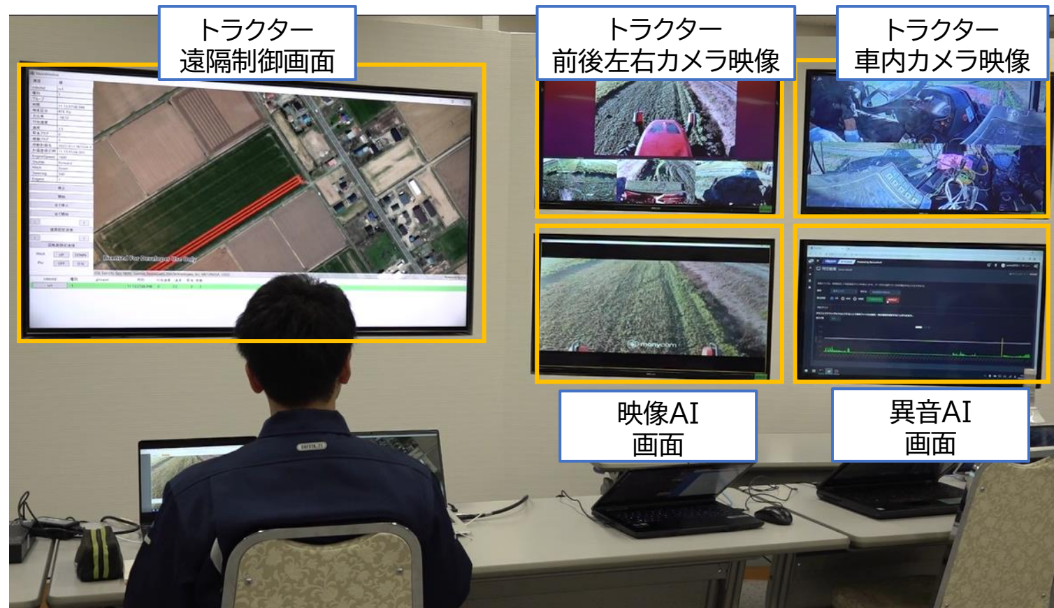
図 IV.7-11 遠隔監視拠点画面構成（自動走行トラクター）
